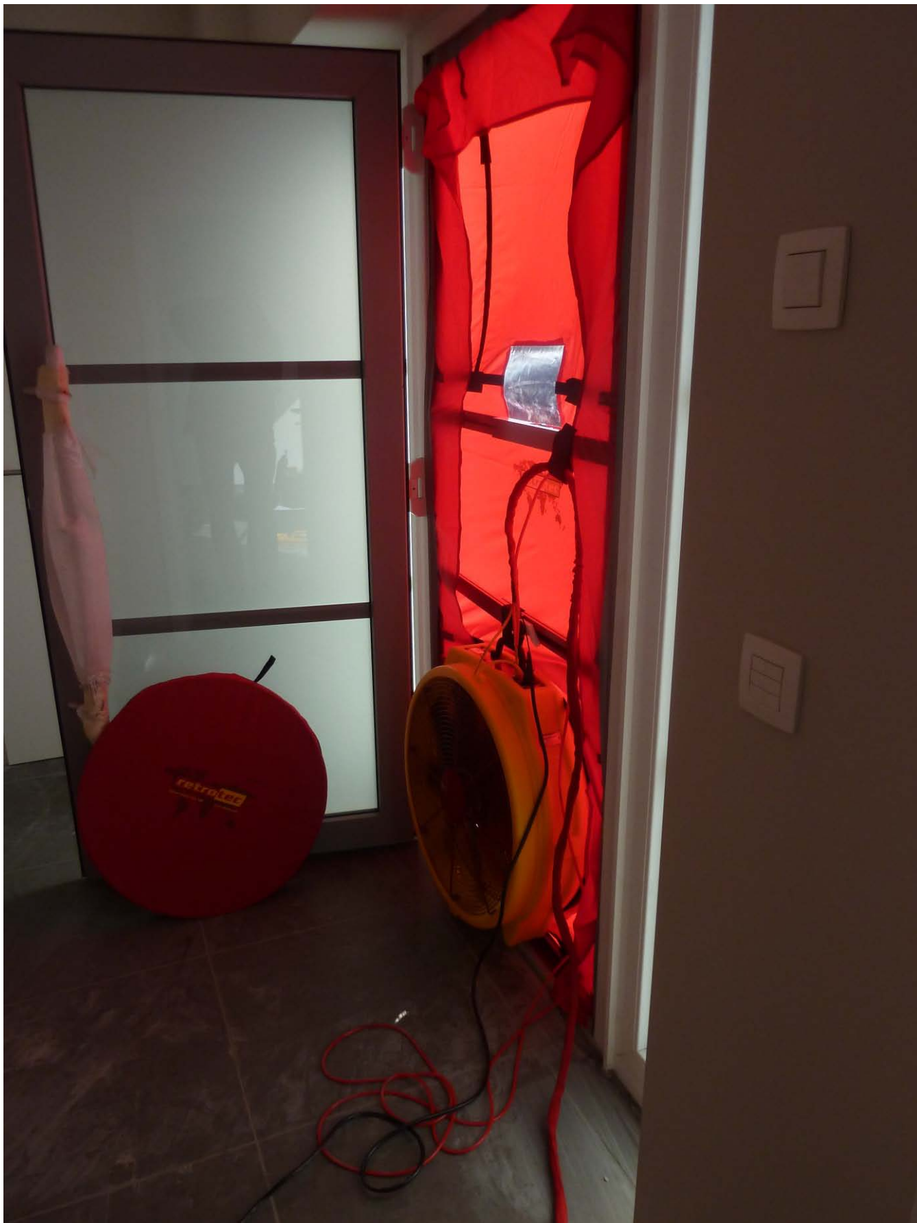
Figure 1 - Blower Door test in uitvoering | EPB LIPA BVBA
